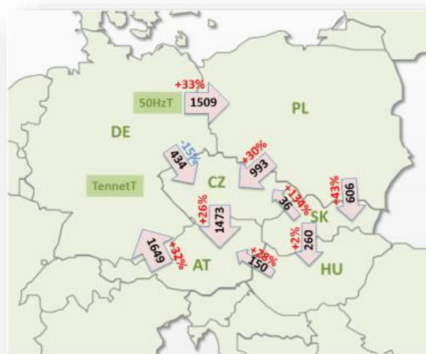
Rysunek 26. Średnia roczna wartość nieplanowych przepływów na granicach Polski i niektórych granicach w regionie Europy Środkowo-Wschodniej w 2015 r. [MW-h] oraz zmiana tej wartości w stosunku do 2014 r. [%]
