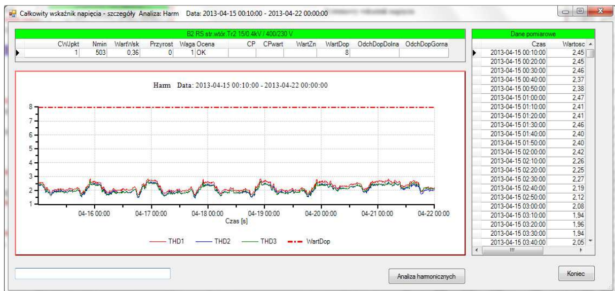
Rys.3. Przebiegi THD dla zadanego tygodnia na podstawie których liczony był wskaźnik odkształcenia napięcia.
